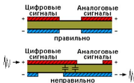
Рис.1. Размещение полигонов аналоговых и цифровых сигналов
